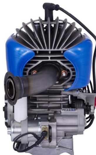
I CONVOGLIATORI DELL'ARIA POSSONO ESSERE MODIFICATI SIA PER AGEVOLARE IL GOMITO DEL PILOTA , SIA PER LO SMONTAGGIO DELL'ACCENSIONE E/O DELLA TESTA DEL MOTORE IN CASO DI VERIFICHE TECNICHE
